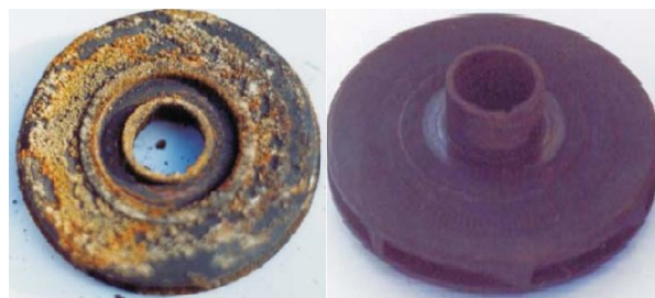
Рисунок 2 – Зовнішній вигляд робочих колес до (а) та після (б) гідродинамічної кавітаційної очистки
