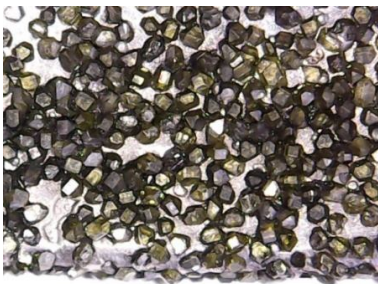
Рисунок 1 – Деградація алмазовмісного шару та викришування алмазних зерен при обробці вуглепластика
