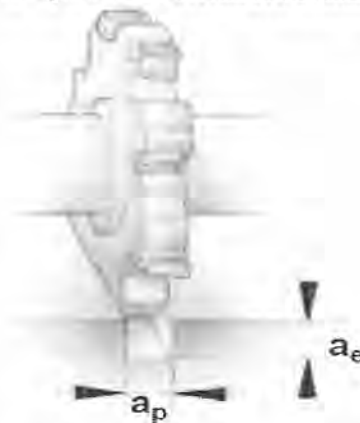
Рис. 2. Г-образная форма срезаемого слоя
