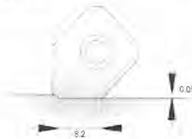
Рис. 4. Схема установки зачистной пластины
