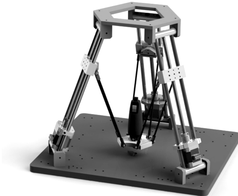
Рис.2. 3D копія верстату пірамідальної компоновки
