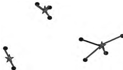
Рис. 1. Суммарные расстояния между точками, представляющими объекты и центрами соответствующих кластеров, представленными звездами – суть критерия метода k -средних
