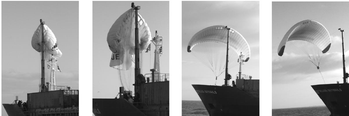
Рис. 2. Початковий етап запуску вітрила системи "SkySails"
