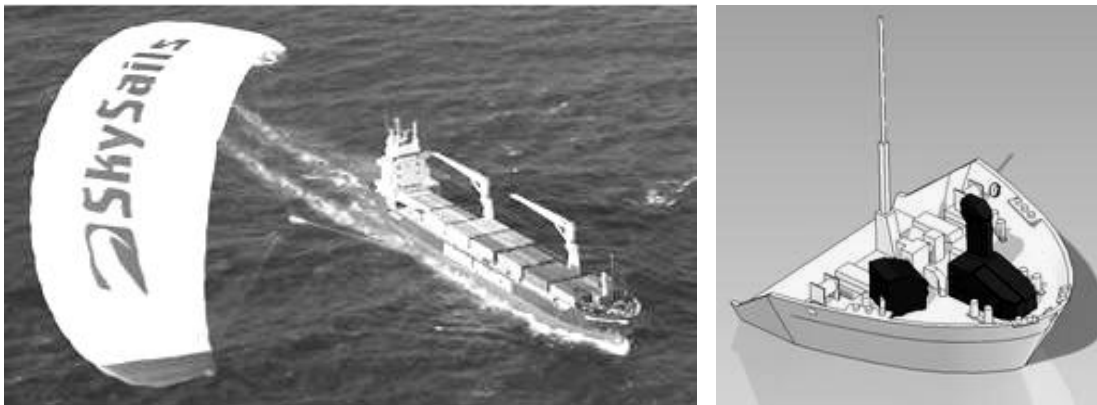
Рис. 1. Система "SkySails" і розташування її додаткових механізмів на баку судна
