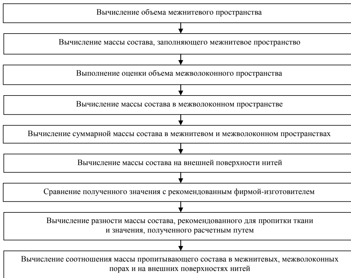
Рис. 3. Схема алгоритма оценки распределения пропитывающего состава в межнитевом и межволоконном поровом пространстве
