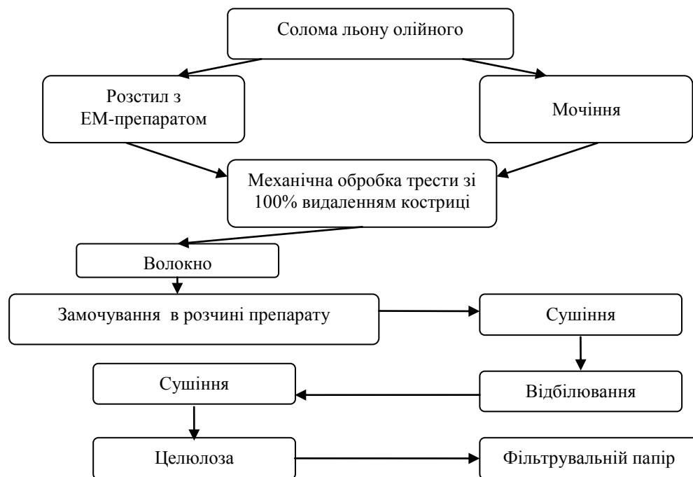
Рис. 1. Технологічна схема одержання целюлози з волокна льону олійного
