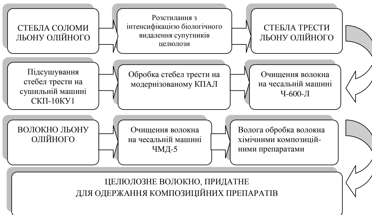
Рис. 2. Технологія первинної переробки луб'яних волокон для одержання целюлозовмісних напівфабрикатів
