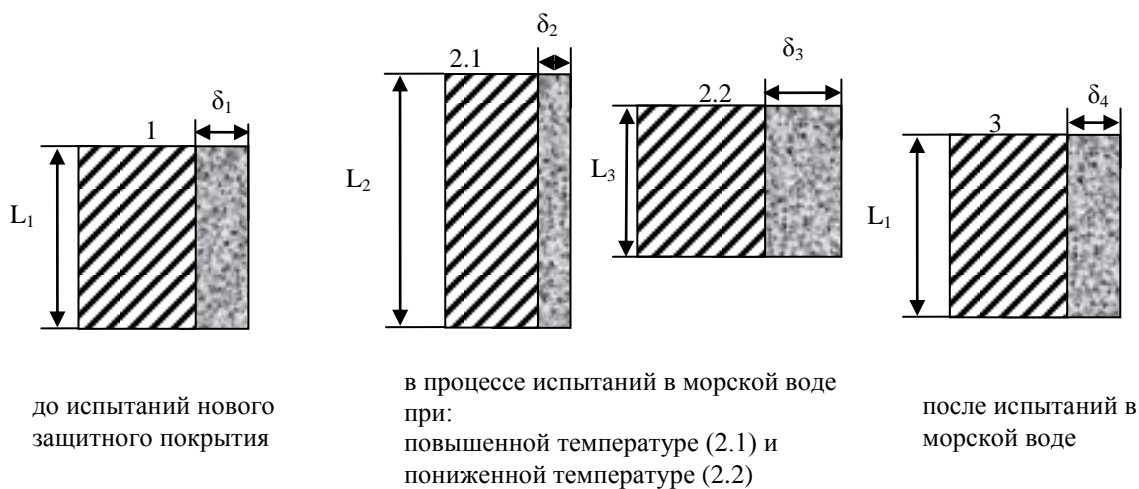
Рис. 5. Изменение толщины защитного слоя металла корпуса судна судов покрытия Б в зависимости от объёмного расширения
