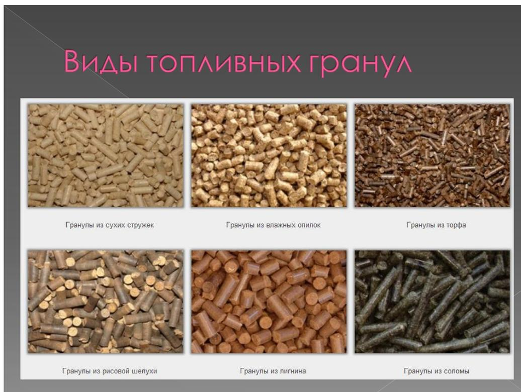
**Рис. 2. Виды топливных гранул из различного растительного сырья**
