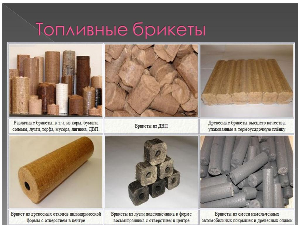
**Рис. 3. Виды топливных брикетов из различного растительного сырья**
