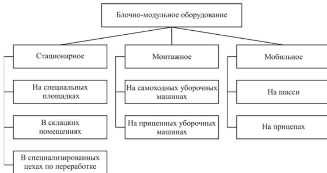
**Рис. 4. Схема классификации оборудования по назначению применения для переработки биологических отходов в топливо**
