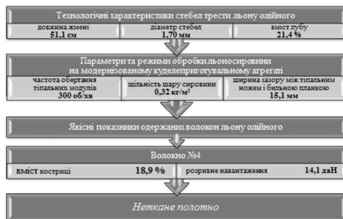
Рис. 1.4. Технологічна схема переробки стебел трести льону олійного сорту Дебют для одержання волокон, придатних до виготовлення нетканних матеріалів типу неткане полотно
