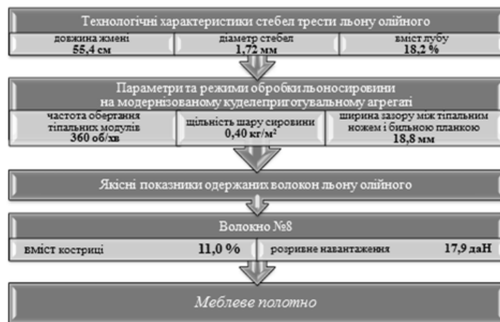
Рис. 1.5. Технологічна схема переробки стебел трести льону олійного сорту Південна ніч для одержання волокон, придатних до виготовлення нетканых матеріалів типу меблеве полотно
