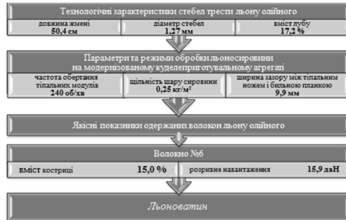
Рис. 1.6. Технологічна схема переробки стебел трести льону олійного сорту Ківіка для одержання волокон, придатних до виготовлення нетканих матеріалів типу льоноватин
