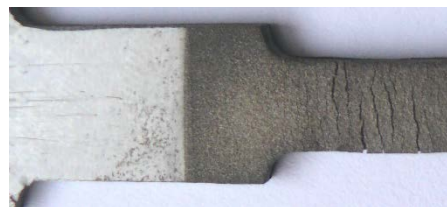
Рис. 5. Сетка трещин в плазменно-напыленном покрытии толщиной 150 мкм
