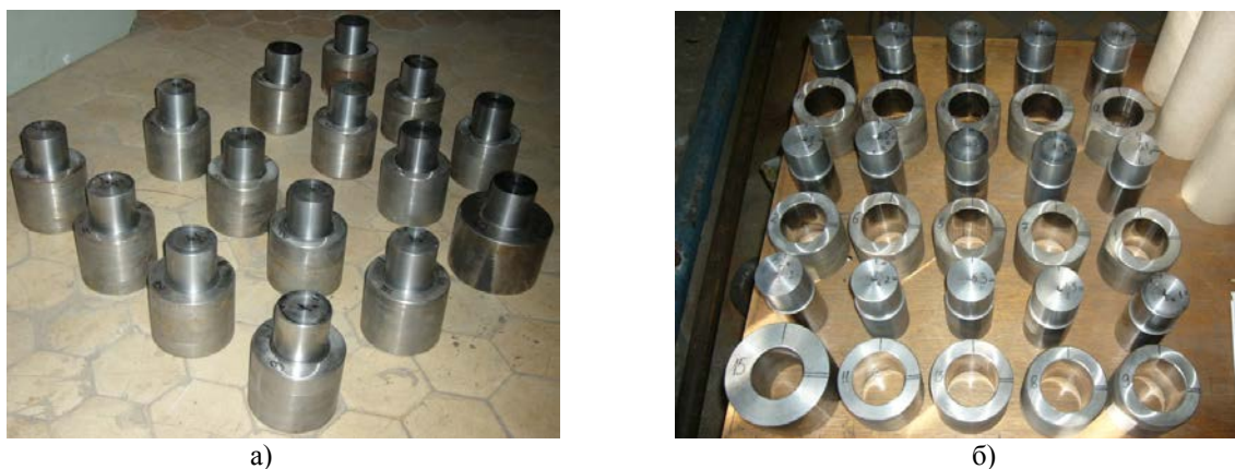
Рис. 3 Экспериментальные соединения до и после распрессовки
