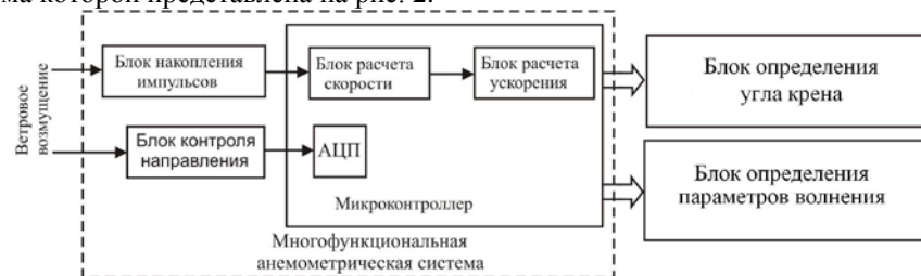
Рис. 2. Функциональная схема многофункциональной анемометрической системы
