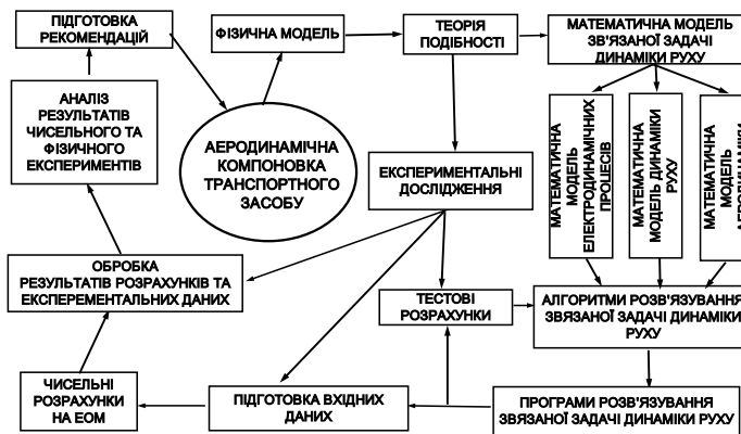
Рис. 1. Структура формування аеродинамічного компоунвання перспективного транспортного апарата
