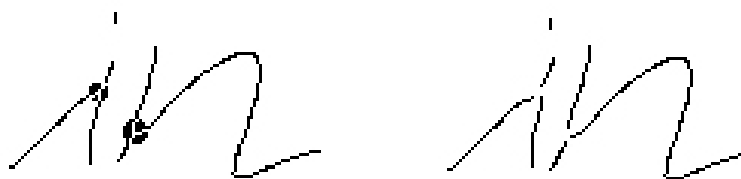
Рисунок 1. а) выделение особых точек (обозначены кругами); б) полученный после удаления особых точек набор графем.
