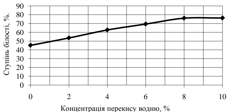
Рис. 4. Залежність ступеня білості тканини від концентрації перекису водню
