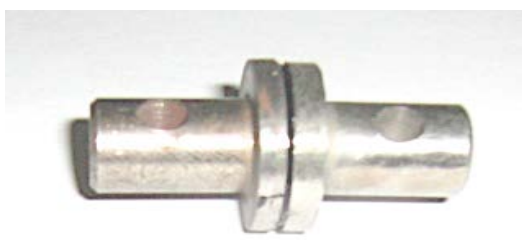
Рис. 2. Визначення адгезії нафтобітумних композицій до сталі
