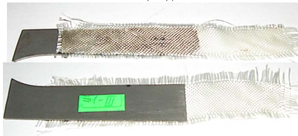
Рис. 3. Визначення адгезії полімерних стрічок до сталі з нанесеним шаром нафтобітумного композиту
