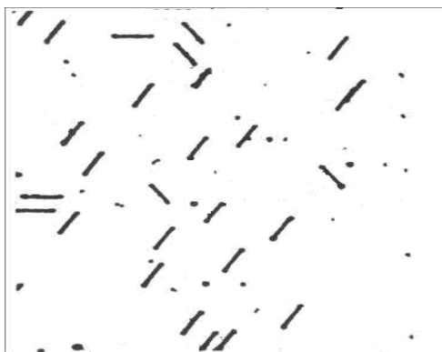
Рис. 1. Микрофотография поверхности структуры кремниевого варикапа после селективного травления
