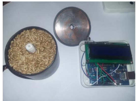
Рис. 3. Модуль вимірювання вологості зерна: а – структурна схема вимірювача вологості; б – внутрішній вигляд модуля
