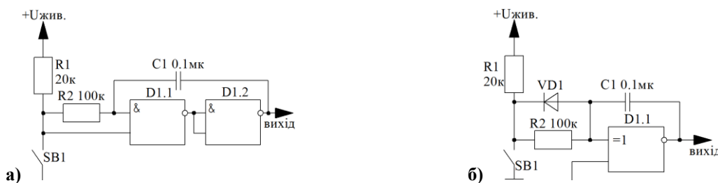
Рис. 4. Схемотехнічні рішення формувачів імпульсних сигналів на основі затримки включення/виключення
