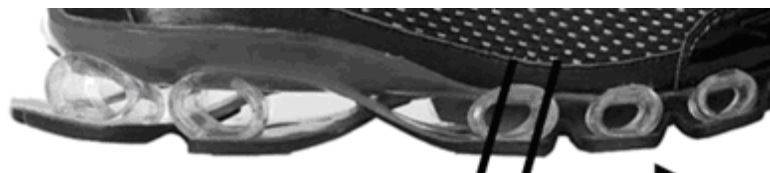
Рис. 2. Деформація трубчастих елементів підшви у процесі носіння взуття
