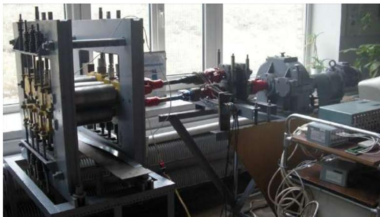
**Рис. 6. Общий вид лабораторной экспериментальной установки с дифференцированным приложением силы правки по ширине полосы**
