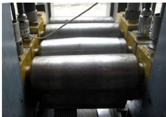
**Рис. 7. Роликовая система листоправильной машины с 3-им роликом бочкообразной формы для имитации изгиба по центру**
