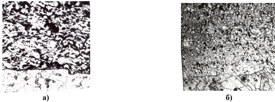
Рис. 3. Микроструктура плазменного молибденового покрытия после обычного напыления (а) и после напыления в динамическом вакууме (б)
