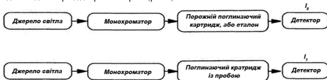
Рис. 4. Принцип кількісного аналізу (визначення відгуків I_0 та I_1 )
