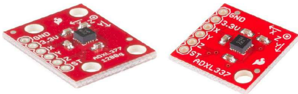
Рис. 7. Акселерометри, побудовані на базі інтегрованих схем: а) - ADXL377; б) - ADXL337
