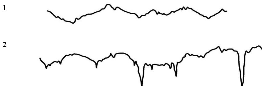
Рис. 3. Профилограммы поверхности образцов из стали 9ХС (HRC 32...64), обработанных точением: 1 – МПО; 2 – в СОТС. Режим обработки: V=1 м/с; S=0,21 мм/об; t=4 мм. Резец Т15К6
