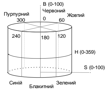
Рис. 2. Схема розподілу інформації про колір у моделі HSB
