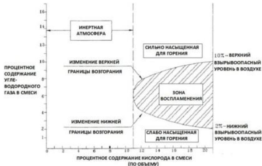
Рис. 1. Общая диаграмма подачи инертных газов для грузовых трюмов танкера
