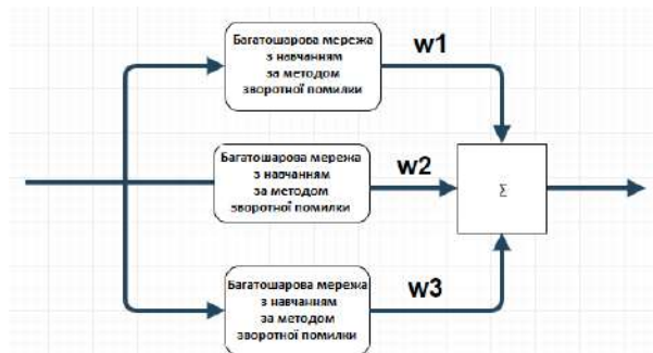
Рис. 2. Структура нейронної мережі з конфігурацію прямого поширення з навчанням за методом зворотного поширення помилки
