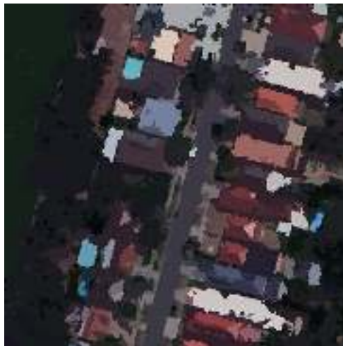
Рис. 4. Результат сегментації зображення методом K-means
