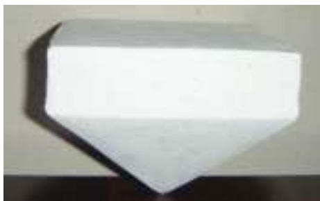
Рис. 1. Образец фигурного элемента мощения с пирамидальным основанием с углом при вершине пирамиды 90^\circ
