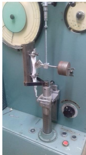
Рис. 2. Дослідження стійкості трикотажу до порізу
