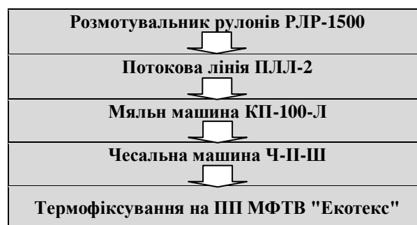
Рис. 2. Технологічна схема виробництва нетканого геоматеріалу з льону олійного
