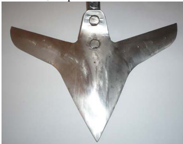
Рис. 1. Розроблений робочий орган культиватора згідно [7]
