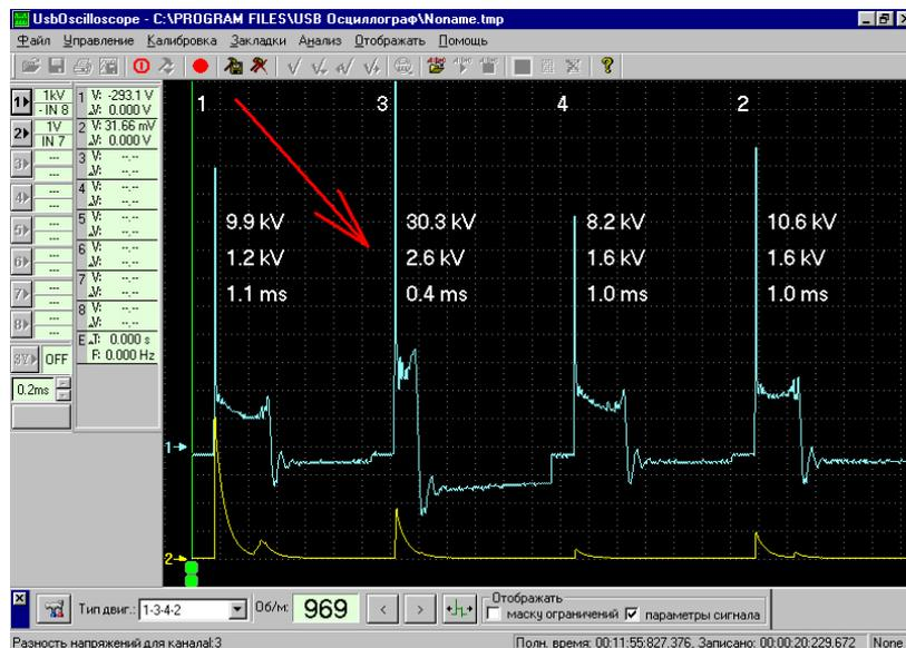
Рисунок 7 - Осциллограмма неисправной серийной системы зажигания
