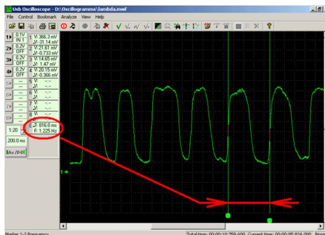
Рисунок 9 - Осциллограмма выходного напряжения лямбда-зонда BOSCH
