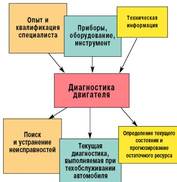
Рисунок 6 - Методика проведения диагностики автотракторных ДВС
