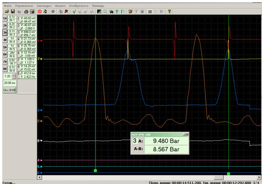
Рисунок 3 - Пример осциллограмм при исследовании рабочего процесса ДВС
