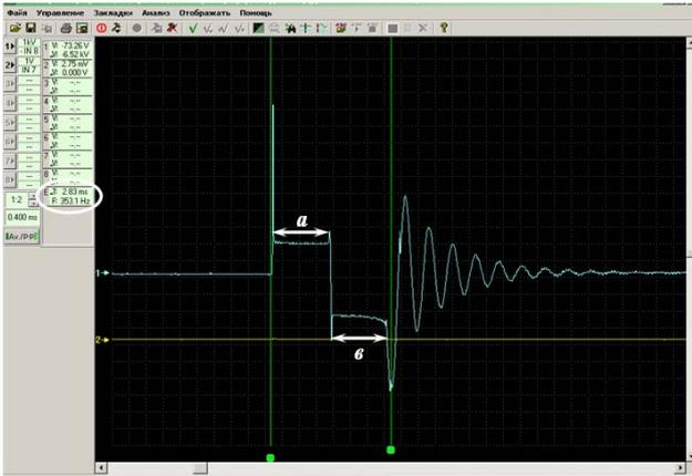
Рисунок 4 - Фрагмент осциллограмми біполярної системи запалювання
