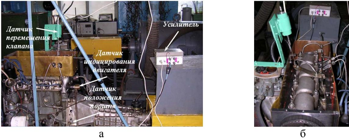
Рисунок 2 - Моторные испытания двигателя VA3-2105
