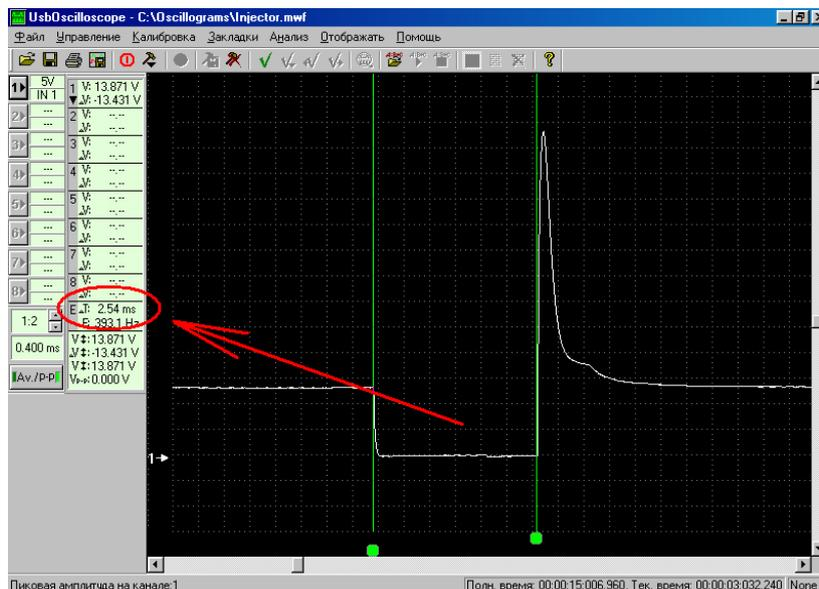
Рисунок 8 - Осциллограмма сигнала управления форсунками
