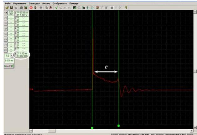
Рисунок 5 - Фрагмент осциллограмми серійної системи запалювання
