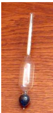
Рис.1. Ареометр для визначення щільності рідини
