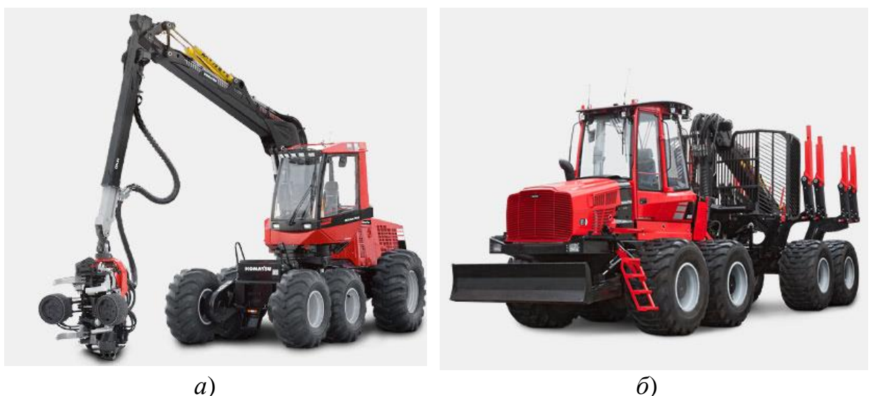
Рис. 1. Багатофункційні лісові машини компанії Komatsu Forest: харвестер 941.1 (а) і форвардер 895 (б)
