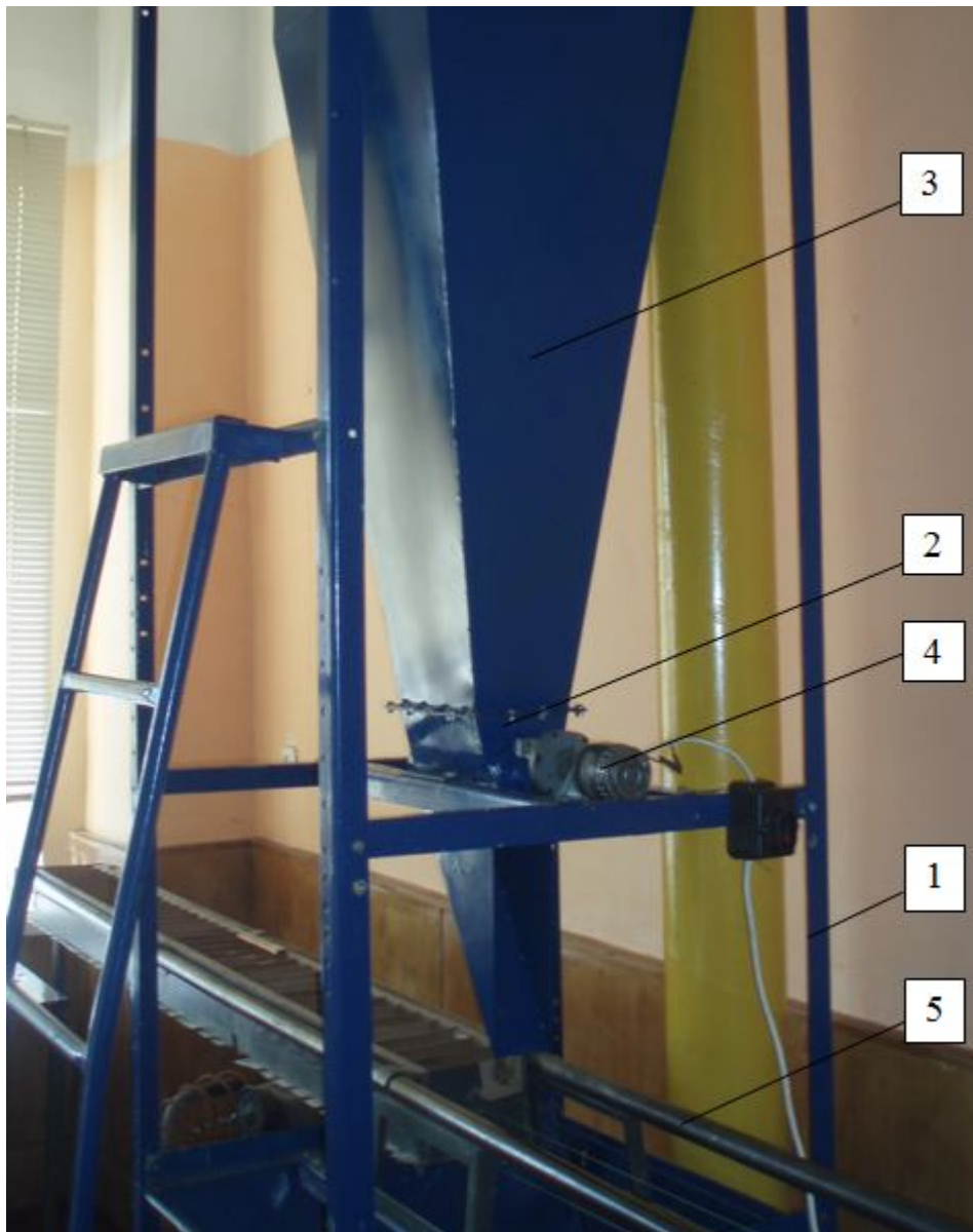
Рисунок 1 – Загальний вигляд експериментальної установки для дослідження процесу дозування концентрованих кормів: 1 – рама; 2 – гравітаційних дозатор; 3 – наддозаторний бункер; 4 – привід дозатора; 5 – пробовідбірник.
