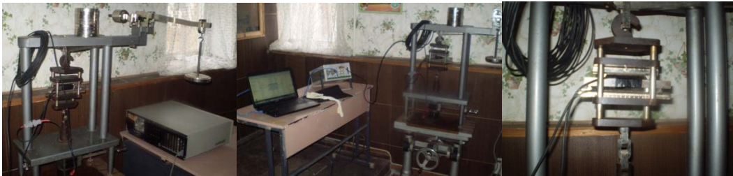
Рисунок 3 – Тарування тензорезисторів на універсальному пресі УП-8
