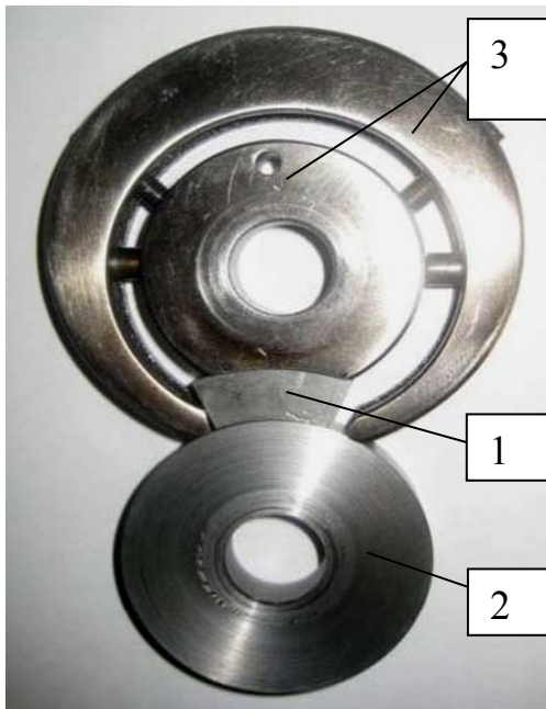
Рис. 1. Взаємне положення зразків при випробуваннях: 1 – колодка; 2 – диск (контртіло); 3 – оправка
