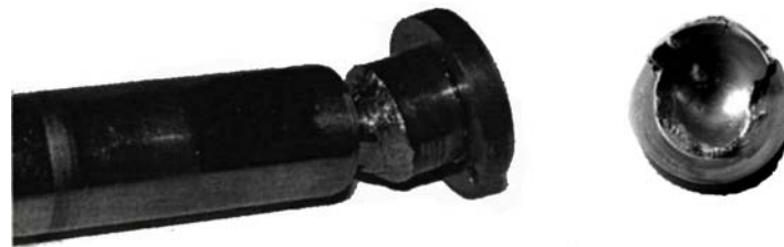
Рисунок 2 – Вид возможного износа поршня и подпятника
