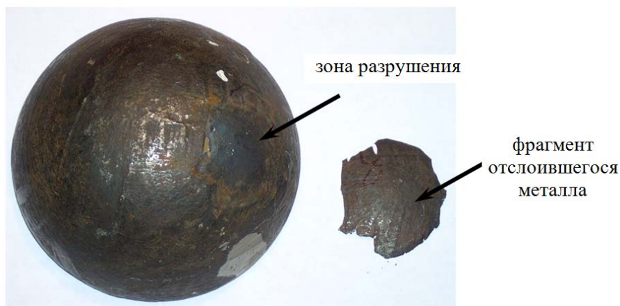
Рис. 6 - Отслоение металла по поверхностному дефекту – плене, ум. \times 1,2
