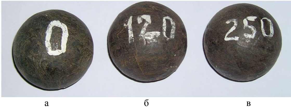
Рис. 1 - Общий вид исследованных катанных мелющих шаров \varnothing 80 мм после закалки (а) и охлаждения до температуры самоотпуска 120°С (б) и 250°С (в), ум.×2,2
