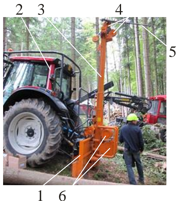
Рисунок 1 - Мобільна канатна установка фірми STEYR: 1-рама; 2-привідний трактор; 3-щогла; 4-направляючі блоки; 5-несучий канат; 6-привідні барабани.
