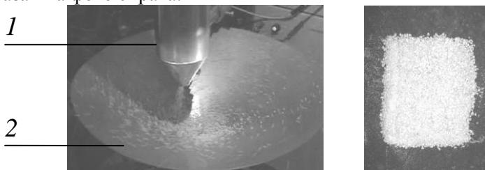
Рис. 1. Процесс сепарации на коническом вращающемся сите под влиянием вертикальной вибрации: 1 – загрузочный бункер; 2 – коническое сито
