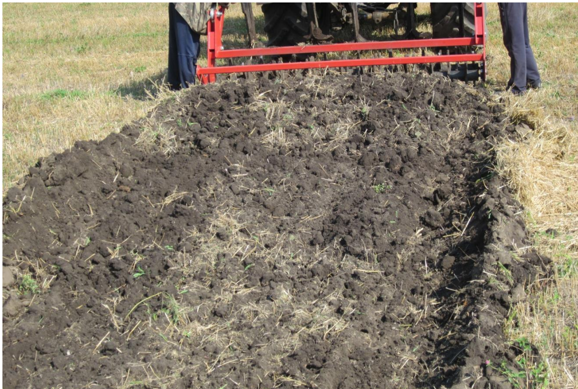
Рисунок 2 - Работа культиватора-глубококорыхлителя с установочной глубиной 20,0см в осенний период (поле после уборки озимой пшеницы):
