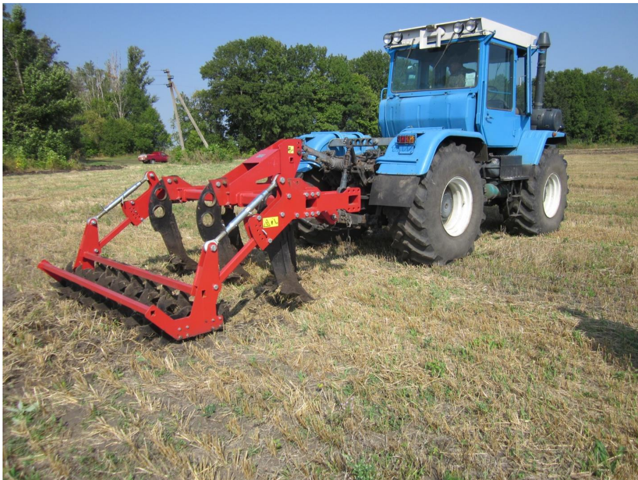
Рисунок 1 - Вид стерневого поля на котором проводились испытания опытного образца культиватора-глубокорыхлителя с трактором ХТЗ-17021
