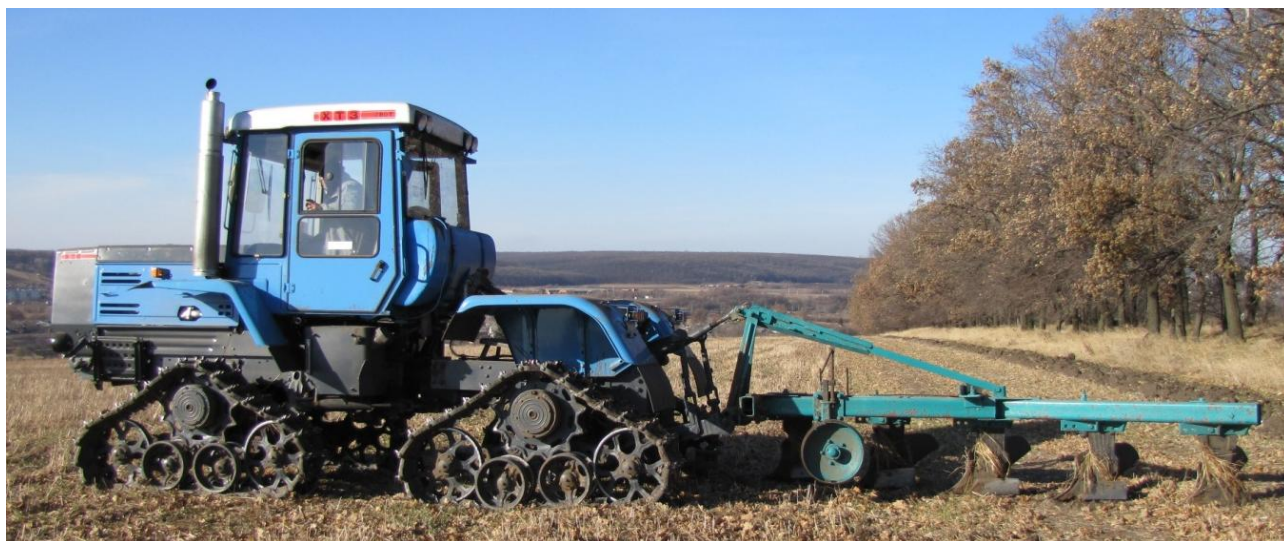
Рисунок 2 – Трактор ХТЗ-280Т в агрегаті з плугом ПЛН-5-35
