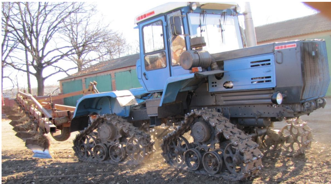
Рисунок 3 – Трактор ХТЗ-280Т в агрегаті з плугом ПН-8-35
