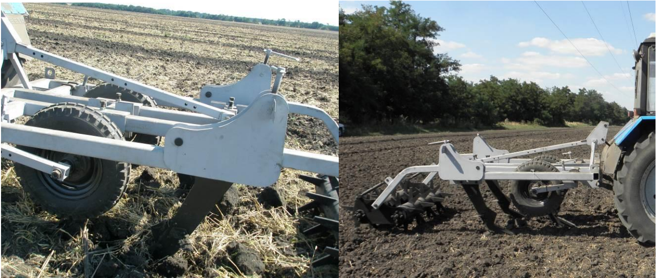
Рис. 3 – Загальний вигляд експериментального комбінованого чизеля
