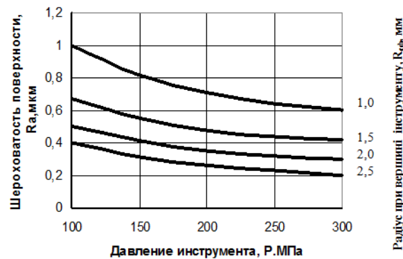
Рисунок 2 - Залежність шорсткості обробленої поверхні R_a від зусилля притискання інструмента P і радіуса при вершині робочої частини інструменту R_{сф}
